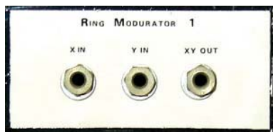
リングモジュレーターのパネル
